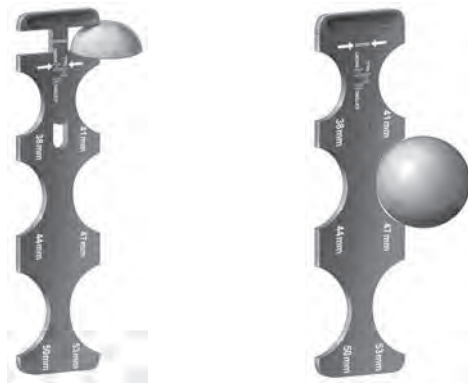
C Messung Kopfhöhe und Durchmesser
