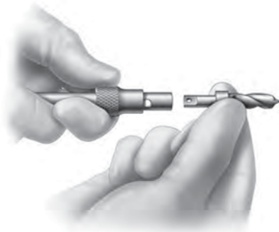
Abbildung 56 Montage des Hohlzapfenbohrers an den Handgriff
