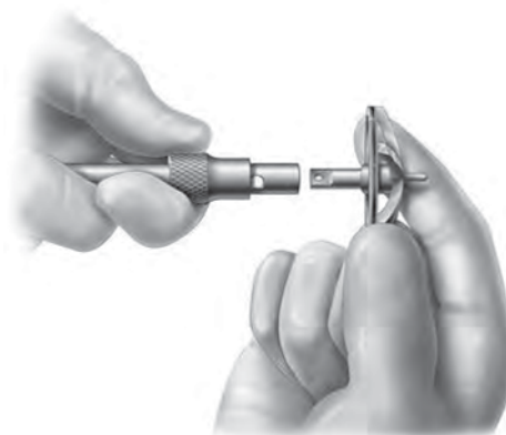
Abbildung 52 Montage des Reverse Fräasers mit Führungsspitze an den Handgriff
