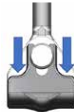
Die Stelle, an der die Abdeckung vom Rahmen abgezogen werden kann
